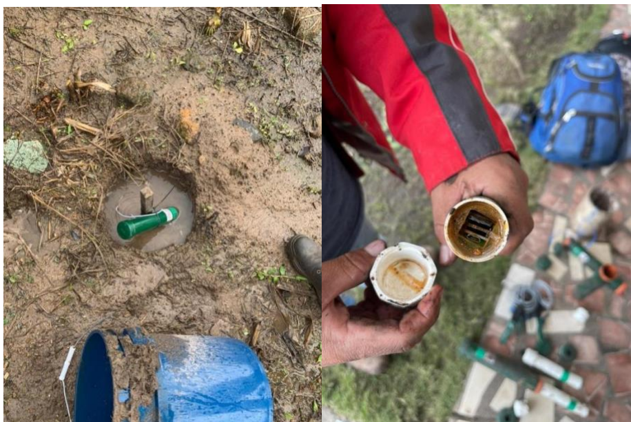
Anexo 3. Sensores instalados en suelos poco profundos con problemas de encharcamiento.
