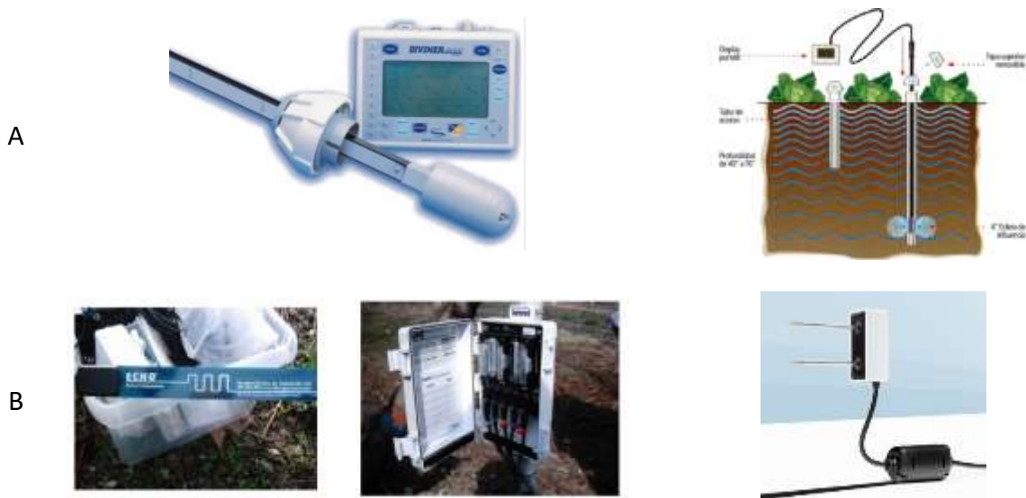
Figura 3. Sensores tipo FDR o de capacitancia. A) Sonda Diviner ® ( www.seedmech.com ; https://agriculturers.com ) B) Sensores Decagon ® modelos ECHO, Teros I10 y datalogger (Angella et al 2016; https://www.alphaomega-electronics.com/es/ )
