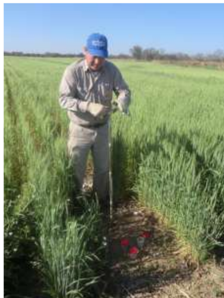
Figura 2. Muestreo de suelos con barreno para determinación del contenido hídrico. (Angella et al 2016).
