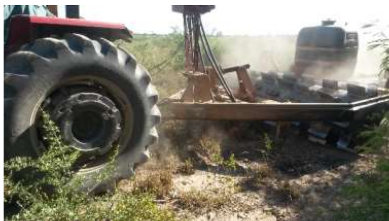
Fotografía 12. Cuchillo corta raíces con rollo, aplicación de defensivo y resiembra de pasto.
